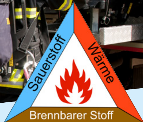
Brennbares Material, Sauerstoff und Wärme bilden das Verbrennungsdreieck
